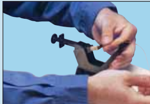
Etapa 6: conexionado del conector
