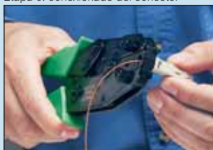
Etapa 6: conexionado del conector
